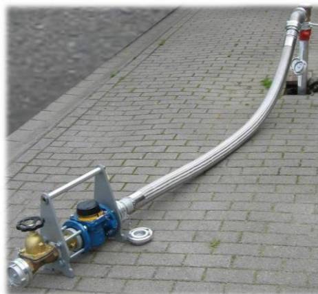
Figuur 2: EVA groot tot 40.000 liter per uur
