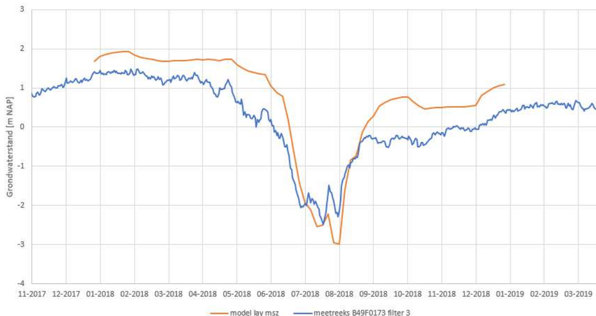
Figuur 6-14: Gemeten en berekende stijghoogtes in 2018 voor meetpunt B49F0173 (Formatie van Maassluis)
