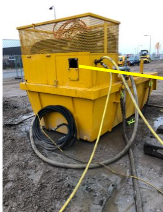
Figuur 7: Vulling doormiddel van vlotter
