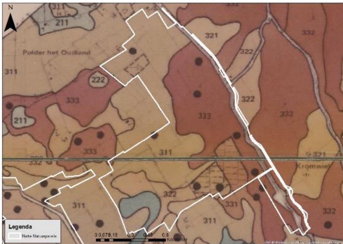
Figuur 3-8: Doorlatendheid per diepteklasse volgens Bles en Steeghs (1974). 1: goed doorlatend, 2: matig doorlatend, 3: slecht doorlatend per laag (0-40, 40-80, 80-120). Code 333 betekent: 0-40: slecht doorlatend, 40-80: slecht doorlatend, 80-120: slecht doorlatend. Punten geven leemvoorkomens binnen 120 centimeter beneden maaiveld. Witte lijn geeft de begrenzing van Oudland (centraal) en Halstersche Laag (links).
