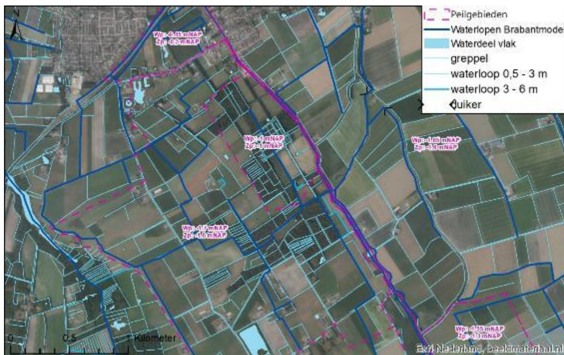
Figuur 3-9: Overzicht Oppervlaktewatersysteem Oudland (waterschap Brabantse Delta 2021). De Waterlopen Brabantmodel komen overeen met de legger van het waterschap.
